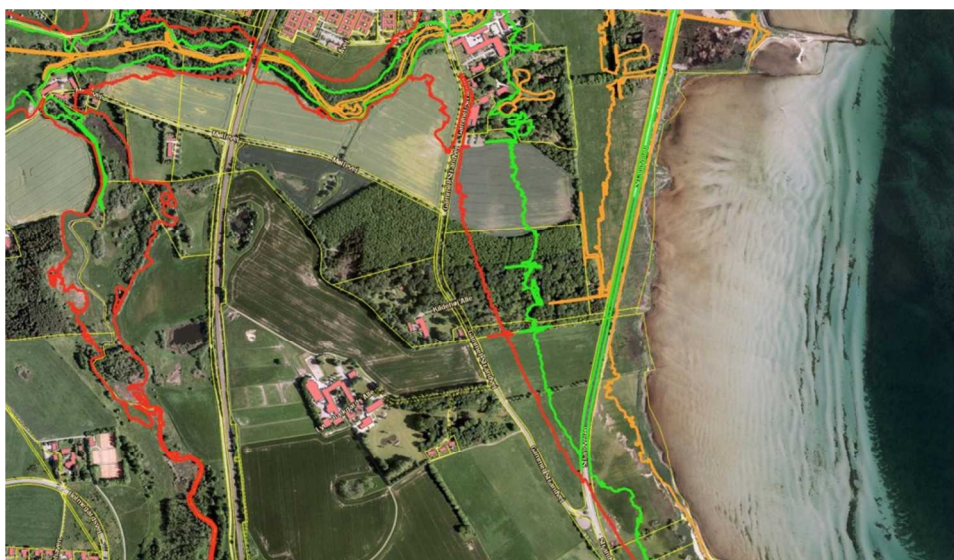
Figur 3-12 Område 2 med flad multirevle strandplan og varierende kystlinje samt højdeindikationer af historisk kystudvikling (gul højdekurve +1m, grøn: +2 m og rød: +3 m DVR90)
