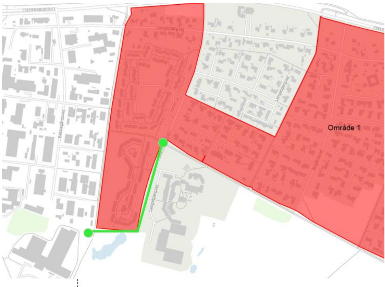
Figur 6.3: Ledning for tilslutning af et nyt varmepumpeanlæg til det eksisterende fjernvarmenet.
